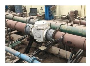
चित्र २. परीक्षण लाइन के साथ फिट माइक्रो हाइड्रो टरबाइन
